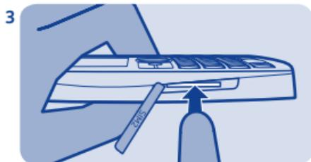
Schieben Sie die Karte ein, bis sie einrastet. Schließen Sie die Abdeckung.
