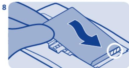
Beachten Sie die Anschlusskontakte des Akkus und setzen Sie den Akku ein.
