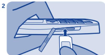
Setzen Sie die SIM-Karte mit Kontaktfläche nach obenweisend ein.
