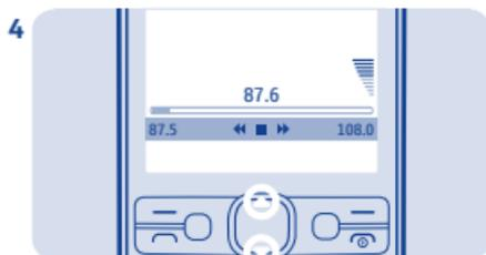
Zum Ändern der Lautstärke drücken Sie die Navigationstasten nach oben oder unten.
