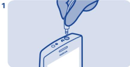
Schließen Sie ein kompatibles Headset an. Das Headset fungiert als Antenne.
