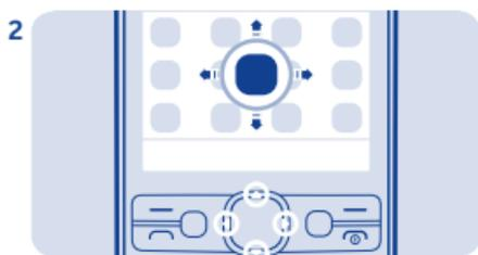
Wechsel zu Programm/Funktion durch Drücken der Nav.-Taste nach oben, unten, links oder rechts.
