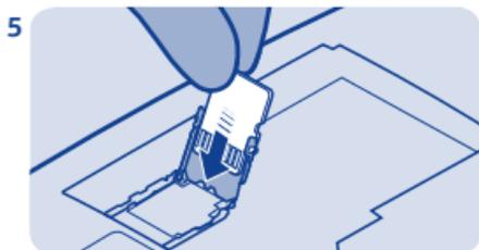
Setzen Sie eine passende Speicherkarte mit der Kontaktfläche nach unten weisend ein.
