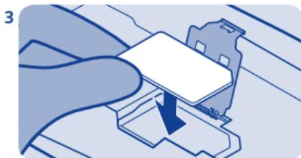
Heben Sie die Abdeckung des SIM-Kartenhalters an. Setzen Sie SIM-Karte so in den Halter ein, dass der Kontaktbereich der Karte nach unten weist. Siehe
