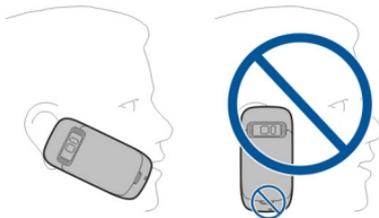
Um eine optimale Geräuschkompensation zu erzielen, halten Sie das Gerät mit dem Hörer an Ihr Ohr und das Hauptmikrofon an Ihren Mund. Verdecken Sie nicht das Zusatzmikrofon auf der Rückseite des Geräts.
