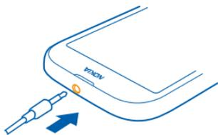
Schließen Sie keine Produkte an, die ein Ausgangssignal erzeugen, da das Gerät dadurch beschädigt werden kann. Schließen Sie keine Spannungsquelle an den Audioanschluss an. Achten Sie besonders auf die Einstellung der Lautstärke, wenn Sie ein externes Gerät oder Headset, das nicht für die Verwendung mit diesem Gerät zugelassen wurde, an den Audioanschluss anschließen.
