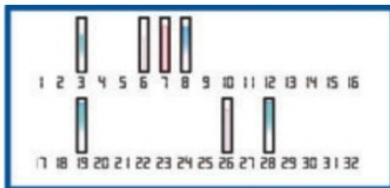
Hat Ihr Gerät Satelliten gefunden, wird für jeden gefundenen Satelliten ein Balken in der Ansicht der Satelliteninformation angezeigt. Je länger der Balken ist, desto stärker ist das Signal des Satelliten. Wenn Ihr Gerät über das Satellitensignal genügend Daten zur Berechnung Ihres Standorts empfangen hat, ändert sich die Farbe des Balkens.
