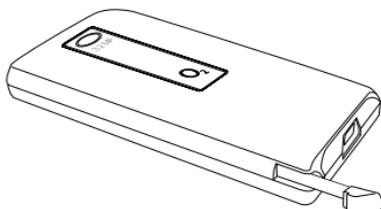
Der Stift ist magnetisch und haftet an der Seite, wenn er in die Nähe des Geräts gebracht wird. Dies verhindert, dass Sie den Stift aus Versehen verlieren oder verlegen.
