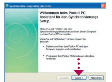
2 Schließen Sie das Gerät an den Computer an. Der Assistent für das Synchronisierungs-Setup startet automatisch und leitet Sie durch die Erstellung einer Synchronisierungspartnerschaft. Klicken Sie auf **Weiter**, um fortzufahren.
