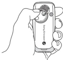
Drehen Sie die Abdeckung der Linse entgegen dem Uhrzeigersinn, um sie zu öffnen.
