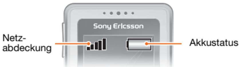
Die Balken illustrieren die Feldstärke des Signals vom GSM-Netz. Wechseln Sie den Standort, wenn Probleme beim Telefonieren auftreten und die Netzabdeckung schwach ist. Kein Netz bedeutet, dass Sie sich außerhalb der Netzreichweite befinden.
