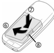
Zum Entfernen auf die Haltetasche drücken ⑧, dann den Akku herausheben. Die Abdeckung auf das Telefon setzen und auf die Oberkante drücken, bis sie einrastet ⑨.
