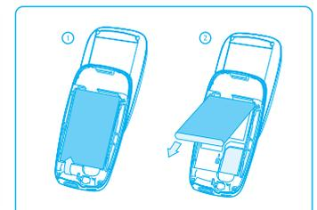
Richten Sie den Akku so aus, dass die Kontaktflächen des Akkus die Kontaktzungen des Mobiltelefons berühren. Drücken Sie den Akku dann unten herunter bis er einrastet.
