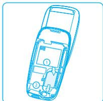
Führen Sie die SIM-Karte mit den Kontaktflächen nach unten in das Kartenfach ein. Die abgeschnittene Ecke ist am Gehäuse markiert. Drücken Sie die SIM-Karte mit dem Finger nach unten ein, bis sie einrastet.
