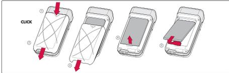
Entriegeln und öffnen Sie den Akkudeckel, lösen Sie den Akku und entnehmen ihn.
